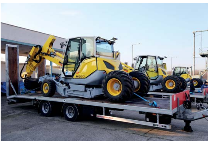
Krčajúce rýpadlo, ktoré umožňuje pohyb priamo vo vodnom toku. Na úpravu vodných tokov a protipovodňové opatrenia získal Slovenský vodohospodársky podnik, š. p. v roku 2015 a 2016 až 240 ks novej techniky.
