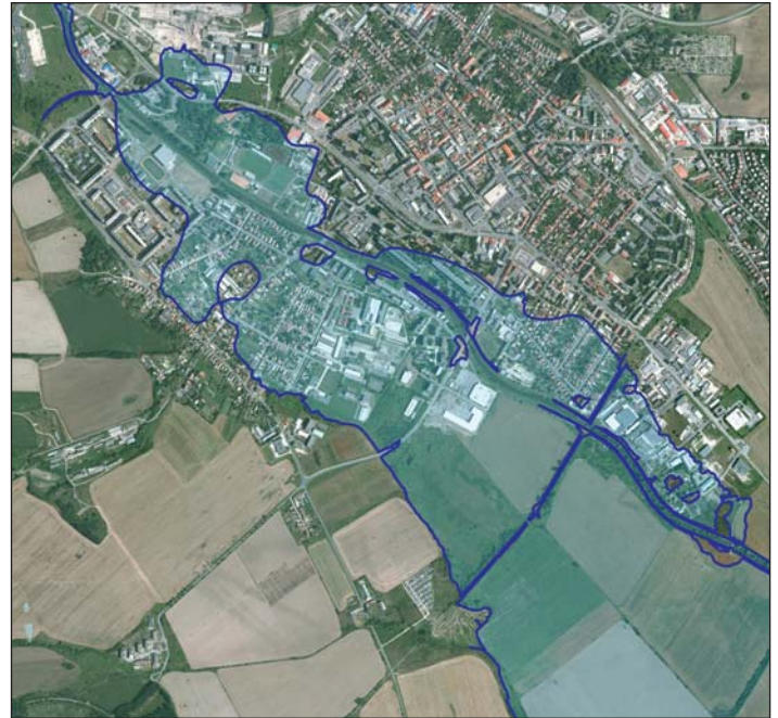
Rimavská Sobota – vymodelovaná záplavová čiara pre tok Rimava, Q = 165 \text{ m}^3/\text{s}
