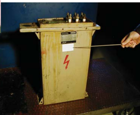
Široká škála kondenzátorov a transformátorov s obsahom nebezpečného PCB
