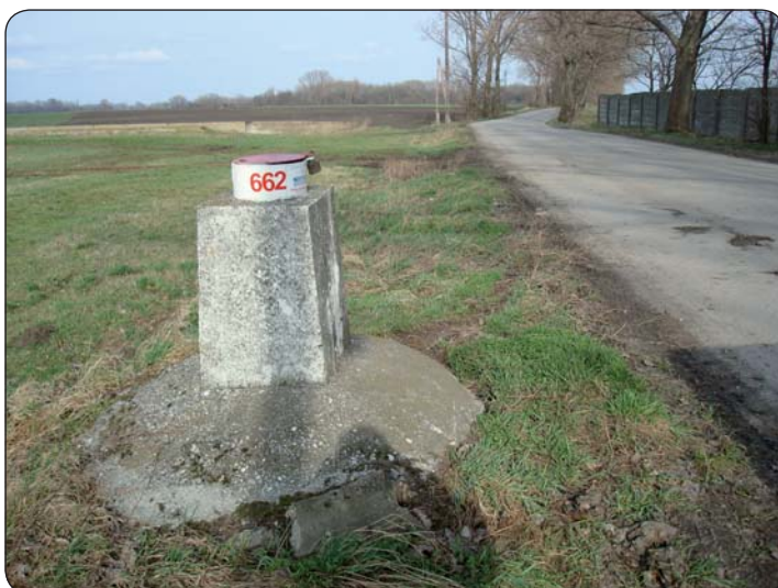
Ukážky pozorovacích sond podzemných vôd štátnej hydrologickej siete
