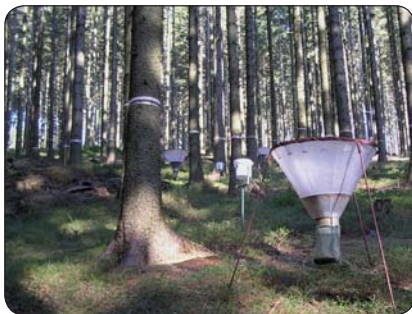
Obr. 1 Jedna z monitorovacích plôch II. úrovne so zariadeniami na zber vzoriek opadu a atmosférickej depozície
