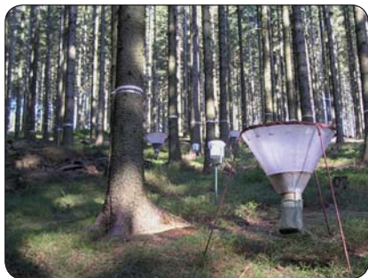
Obr. 1 Jedna z monitorovacích plôch II. úrovne so zariadeniami na zber vzoriek opadu a atmosférickej depozície
