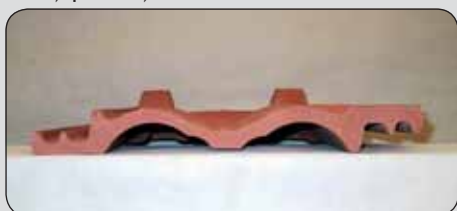
Obr. 7 Rez pálenej krytiny aplikáciou priemyselného odpadu a pri zachovaní rýchleho režimu pálenia
