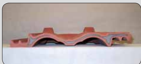
Obr. 6 Rez pálenej krytiny s redukčným jadrom pri rýchlom režime pálenia
