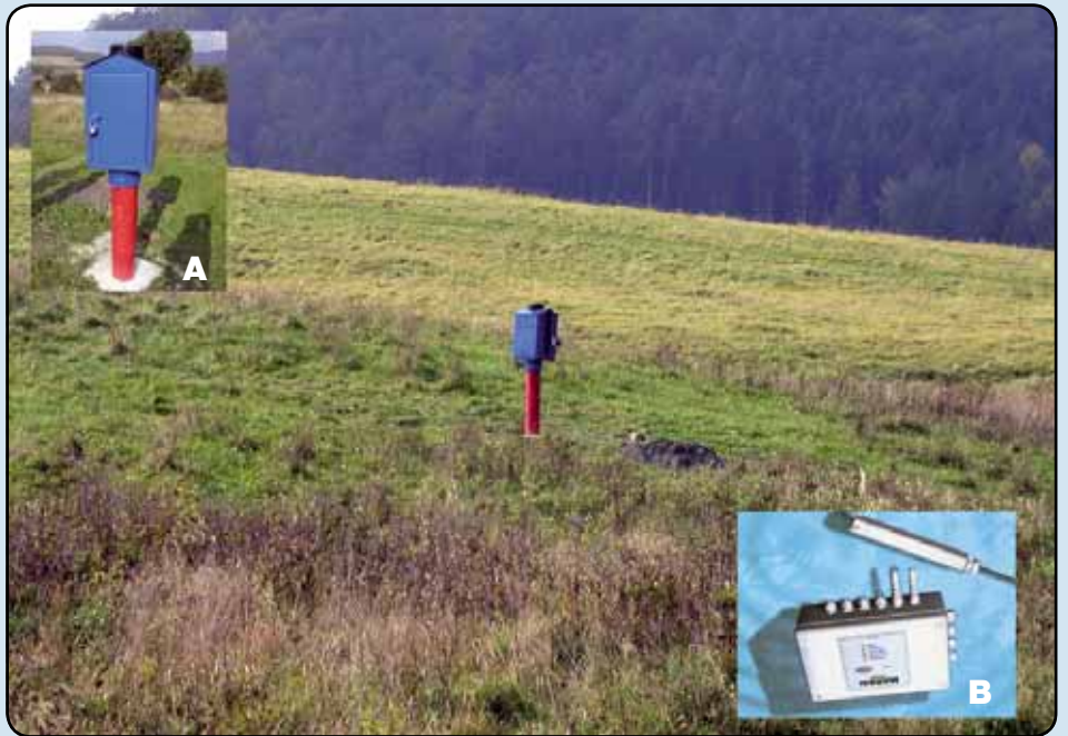
Datalogger MARS5i na zosuvnom území Veľká Čausa. A - umiestnenie prístroja v ochrannom zariadení vo vrte AH-1, B - datalogger a meracia sonda
