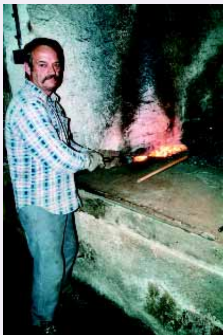
Kováč žeraví železný polotovár na ohnisku
