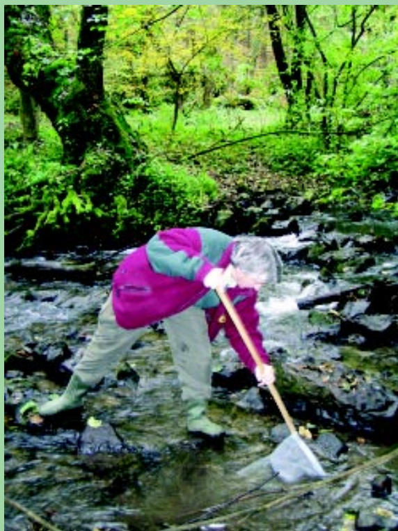
Odber vzorky z rieky Blh pomocou predpisanej sieťky
