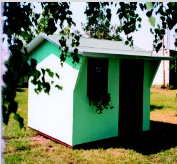
Záhradný domček obložený stavebnými doskami z tetrapaku
